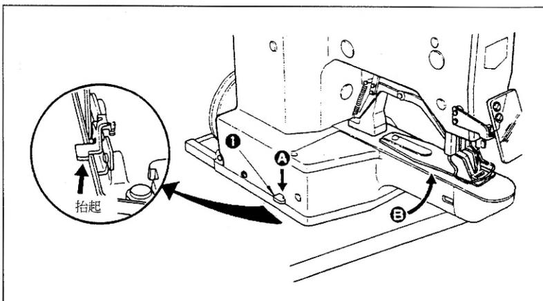
1. 卸下皮帶外罩，在縫紉機頭安裝在機台的狀態下，向下（箭頭❶）按機台鎖定器❶，把縫紉機沿箭頭❷方向抬起。
