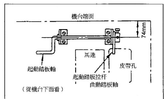
\*1. 因為帶環縫紉機橫向使用縫紉機頭，所以請參照上圖使用附屬的踏板壓腳。踏板的操作變得更為簡單。
